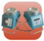
เครื่องเก็บตัวอย่างเชื้อแบคทีเรีย และเชื้อราในอากาศ (Total Fungi & Total Bacteria)
